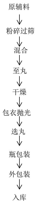
图 3-5 丸剂工艺流程示意图
