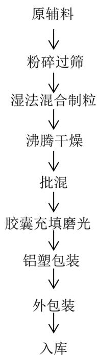
图 3-5 胶囊剂工艺流程示意图
